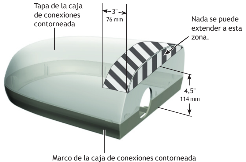
Figura 56. Tapa y marco de la caja de conexiones contorneada
