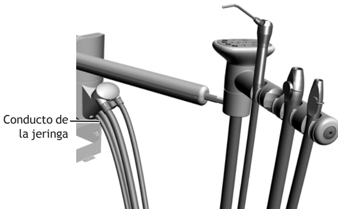
Figura 33. Colocación del conducto de la jeringa
