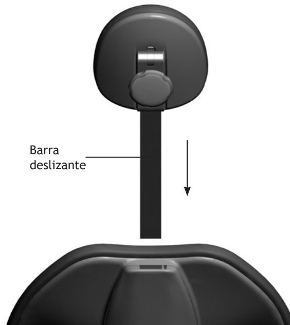
Figura 98. Instalación del apoyacabezas de doble articulación
