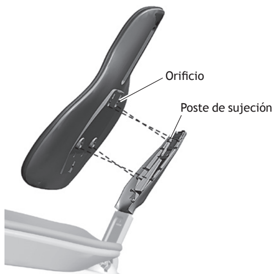
Figura 95. Instalación del tapizado del respaldo
