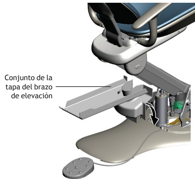
Figura 147. Instalación del conjunto de la tapa del brazo de elevación
