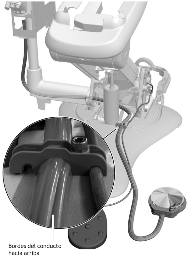
Figura 90. Fijación del conducto del control de pie
