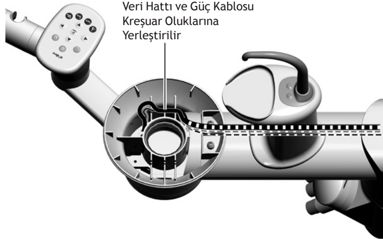
Şekil 25. Dokunmatik Panelle Yapılan Bağlantının Üstten Görünümü
