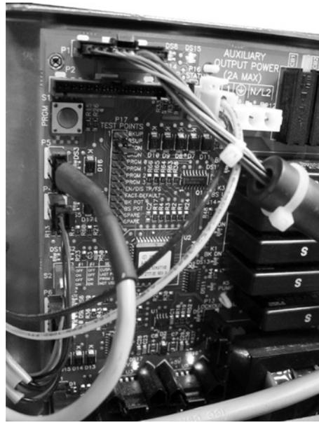
Abbildung 77. Anbringen der Halteklammer innen im abgesetzten Anschlussgehäuse
