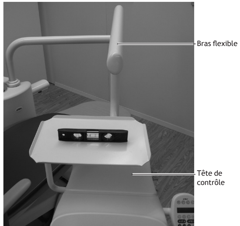
Figure 119. Unit prêt à être nivelé
