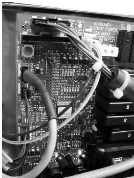
Figure 76. Circuit imprimé du fauteuil sans port de données
