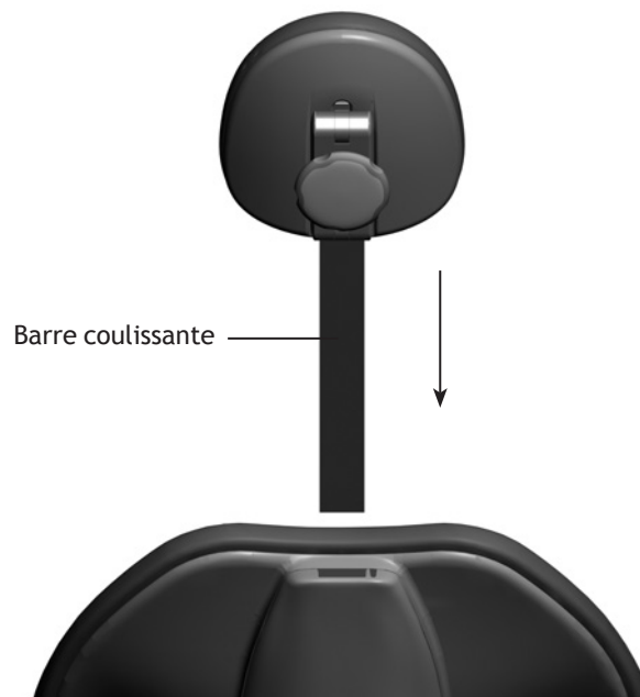
Figure 98. Installation de la tête à double articulation
