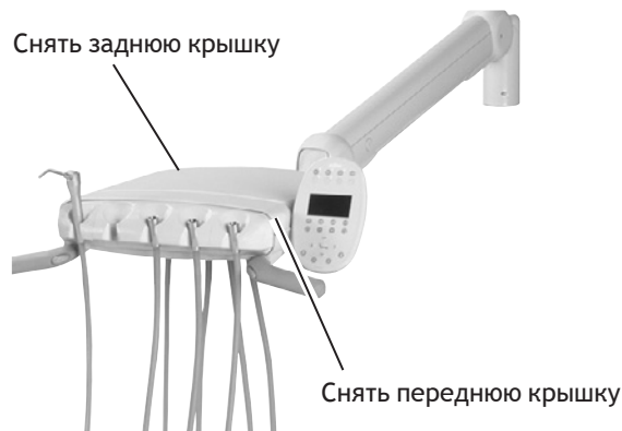
Рисунок 18. Крышки модуля управления Traditional
