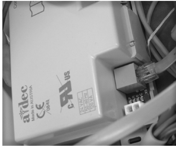
Рисунок 26. Подключение кабеля передачи данных
