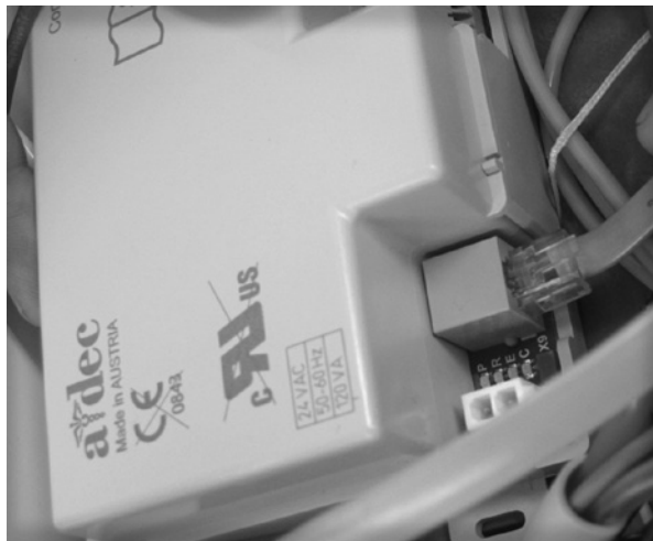
Рисунок 9. Подключение кабеля передачи данных
