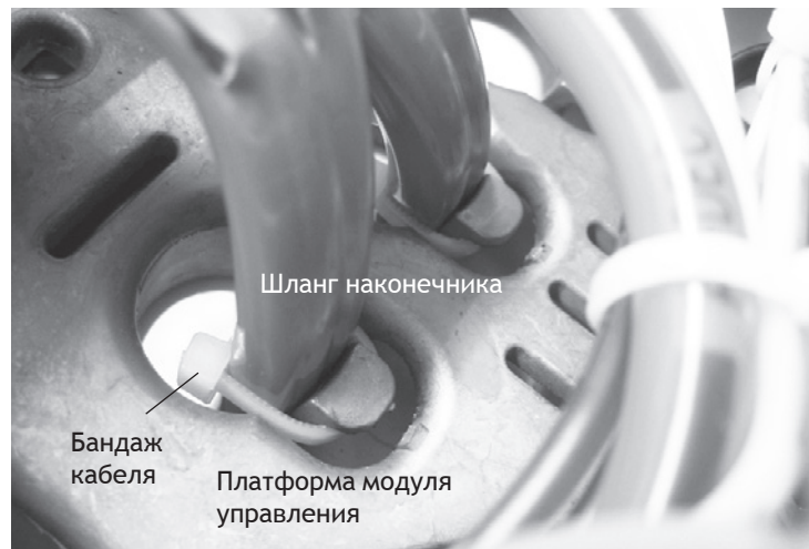
Рисунок 3. Установка шлангов в систему Traditional
