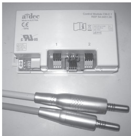
Рисунок 1. Модуль управления CM-2.1 с электромотором A-dec EA-30 и/или EA-52LED
