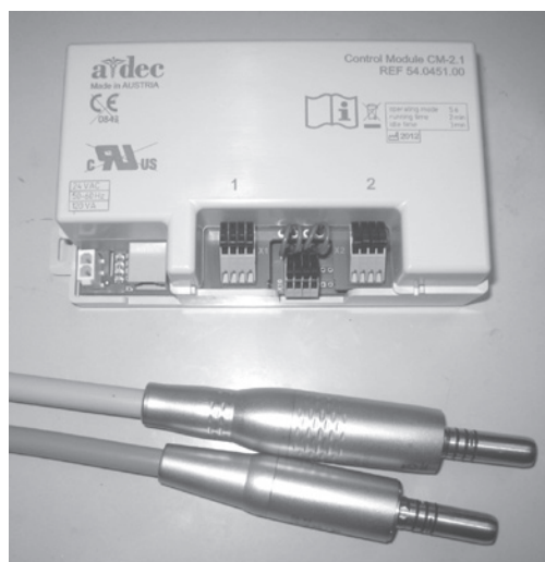
図 1. CM-2.1 コントロールモジュールと A-dec EA-30 または EA-52 LED 電動モーター
