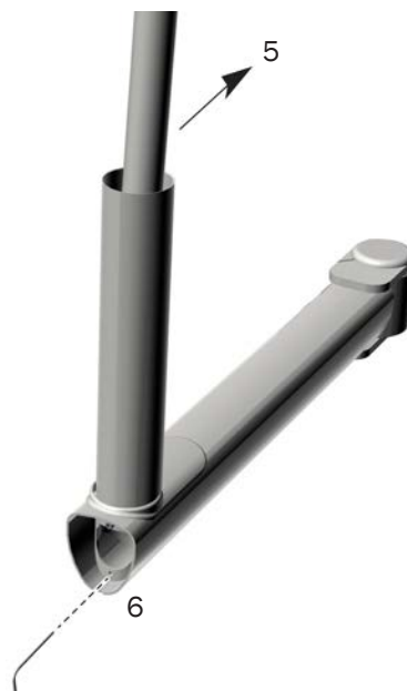
図84. ライト支柱を固定する
