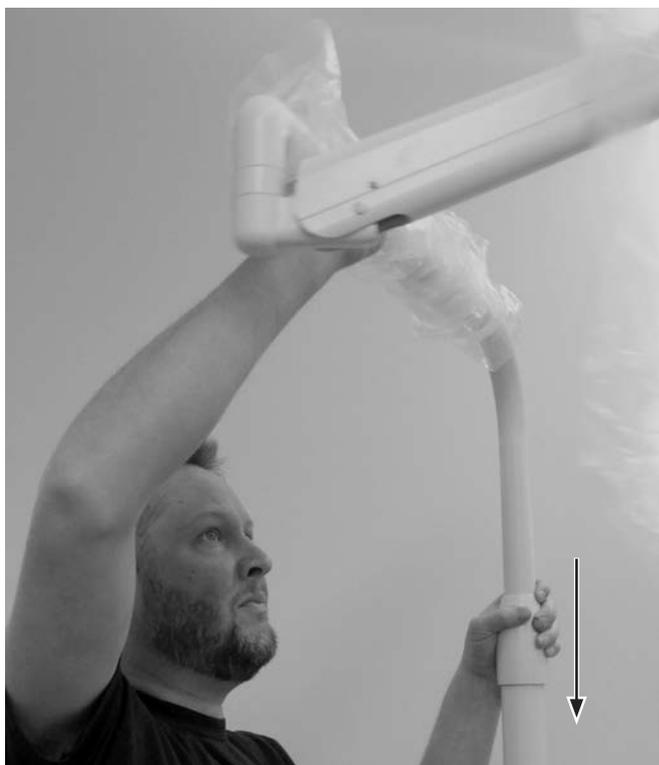
**1** Insérer l'éclairage dans la colonne inférieure.
