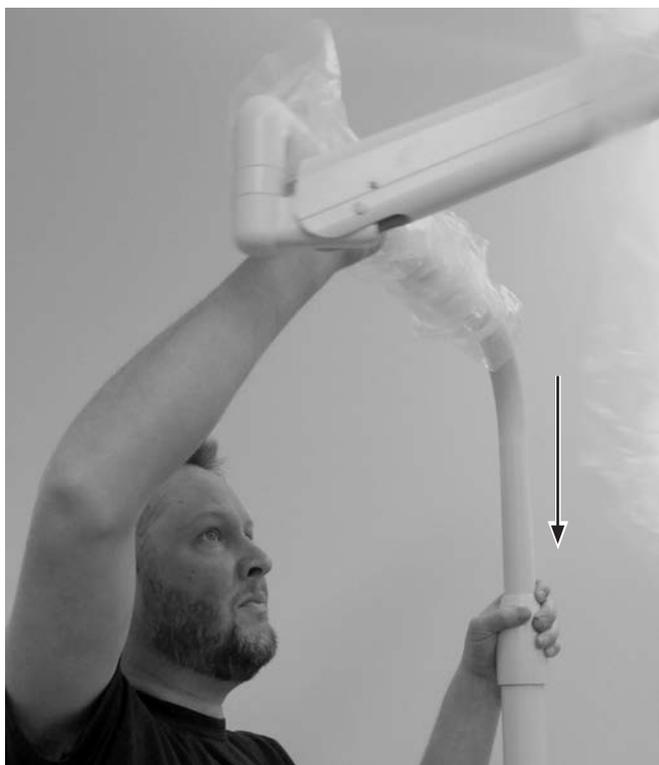
**1** Insérer l'éclairage dans la colonne inférieure.
