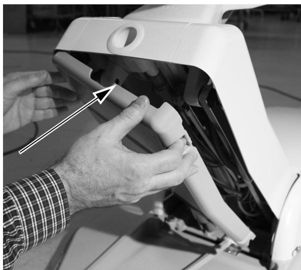
**1** Установите стопорную пластину на место.
