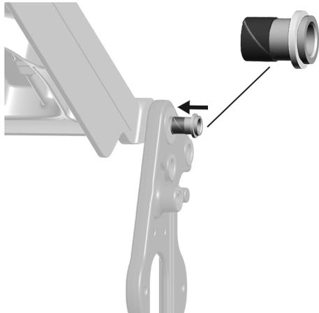
4. Setzen Sie die neue Schraube mithilfe des Gewindeeinsatzes und des Abstandhalters ein.
