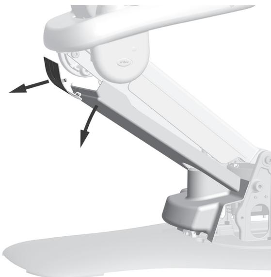
6. Ziehen Sie die Hebearmabdeckung nach oben und entfernen Sie sie sowie die untere Hebearmabdeckung vom Stuhl.
