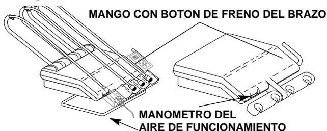
Figura 2. Manómetro del aire de funcionamiento
