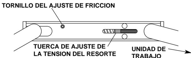
**Figura 18. Ubicaciones de los ajustes de la tensión**
