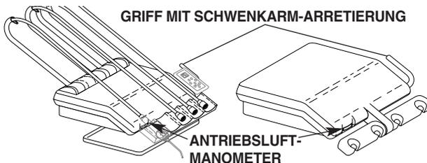
**Bild 2. Antriebsluft-Manometer**
