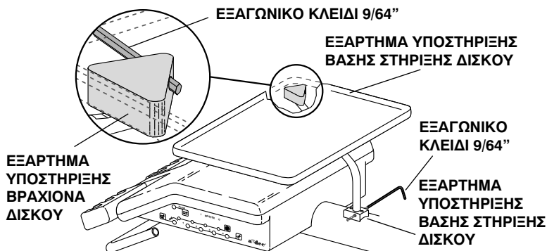
Εικόνα 15. Συγκρατητής Δίσκου/Ρύθμιση Τάσης Βραχίονα Δίσκου (Παραδοσιακού Τύπου)
