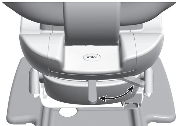
Les fauteuils sur pivot peuvent effectuer une rotation de 30° maximum de part et d'autre du pivot. Le frein de pivot du fauteuil limite la rotation du fauteuil pour l'empêcher de bouger durant une procédure.
