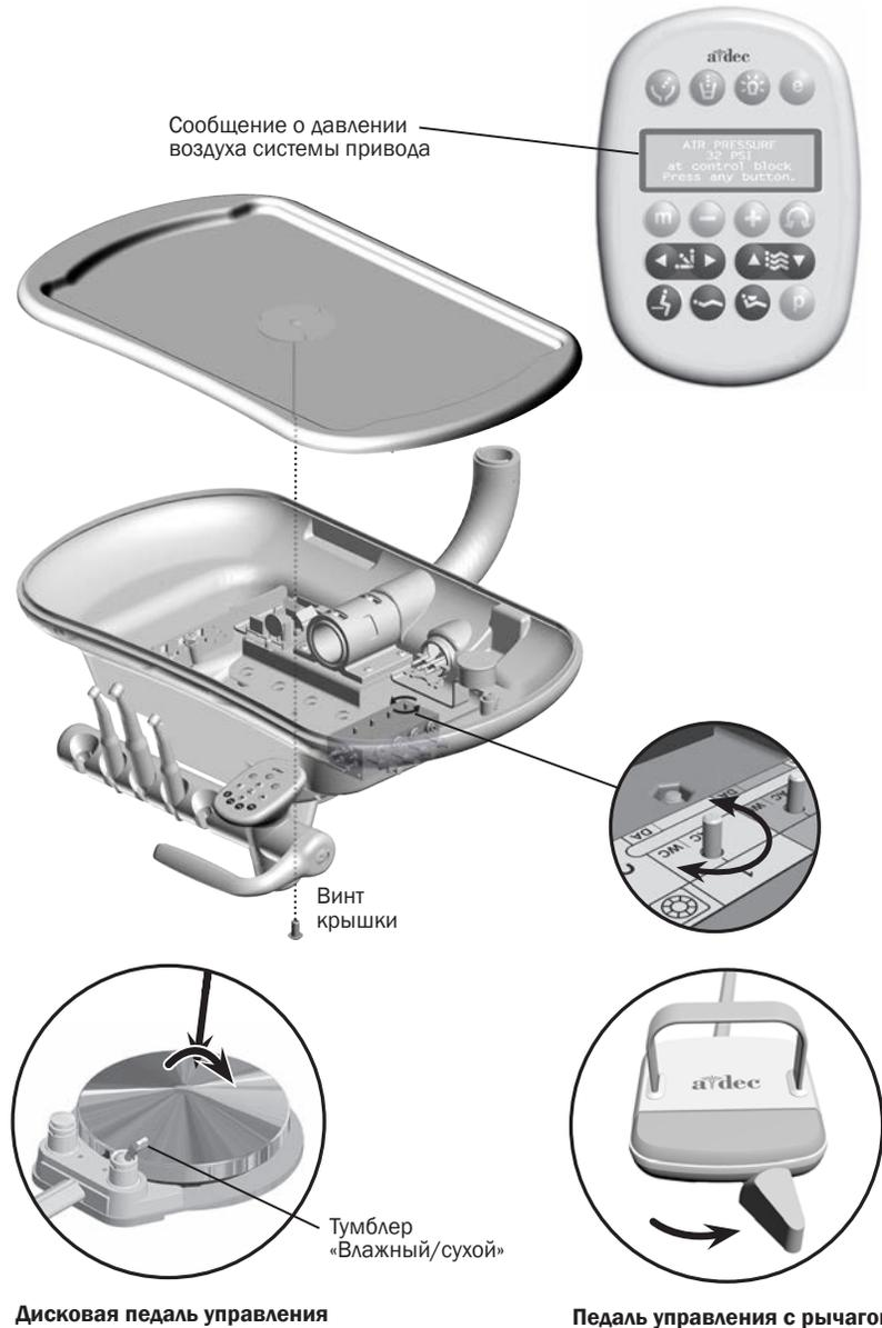
На сенсорной панели управления «Делюкс» можно проверить давление воздуха системы привода, нажав одновременно кнопки «плюс» (+) и «минус» (-). В системах со стандартной сенсорной панелью управления и для обеспечения максимальной точности измерения давления воздуха системы привода используйте манометр (A-dec, № по каталогу 50.0271.00), прикрепленный к шлангу наконечника.
